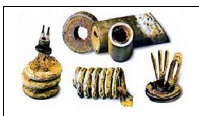
Slika 2–1: Posledica vodnega kamna na vodovodnih instalacijah. [6]
