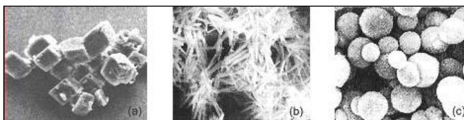
Slika 2–6: Mikroskopska slika kristalov kalcijevega karbonata pri 1000-kratni povečavi.
